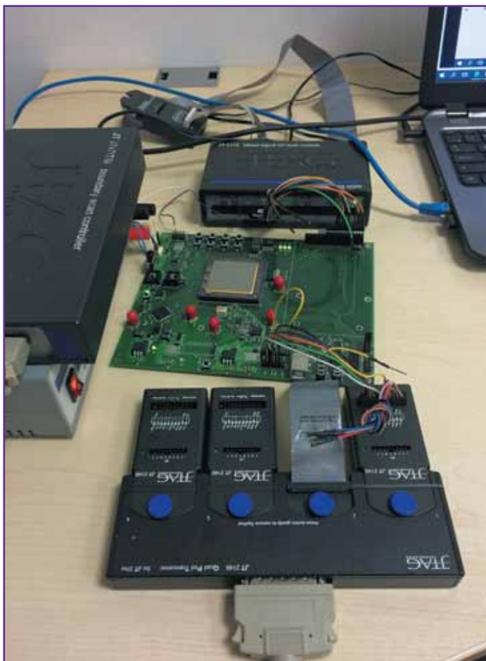
Рис. 1. Отладочная плата для микросборки «Осведомленность» и установка периферийного сканирования
